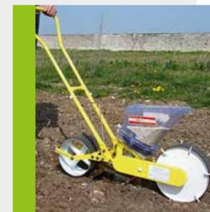
Ces semoirs ont été créés pour semer les grosses graines comme les fèves, les haricots de Soissons mais également le pois et le maïs. La trémie, d'une capacité de 5 litres, est parfaitement adaptée à ces espèces.
