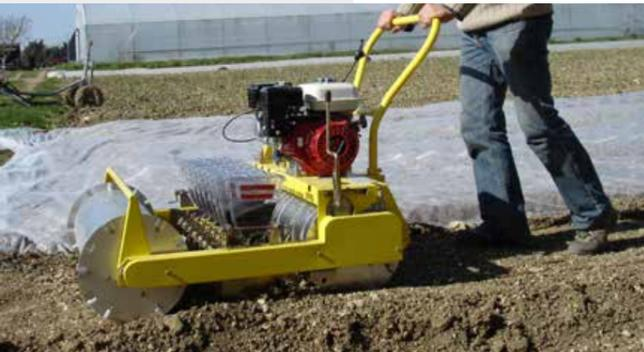
Ces semoirs sont parfaits pour les semis de radis, roquette et jeunes pousses, en planche de 60, 90 et 120 cm (6 à 12 rangs simples, doubles ou en bande), avec un écartement entre éléments de 7,5 cm minimum.
