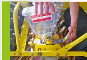
Le fonctionnement des semoirs "petites graines" repose sur l'utilisation d'une trémie déclipable, à l'intérieur de laquelle se loge un rouleau de semis. L'ensemble des paramètres assurant un travail de qualité sont très facilement réglables : type de semis (en ligne, en poquet, en graine à graine), distance entre les graines sur le rang, profondeur de semis, recouvrement du sillon et espacement entre les rangs.
