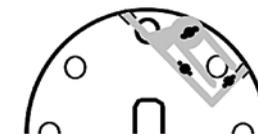
→ **SAATABSTÄNDE:** Die Saatabstände werden durch Drehen an den Zahnrädern und Verändern der Lochzahl der Walze eingestellt. Siehe Tabelle der Saatabstände.
