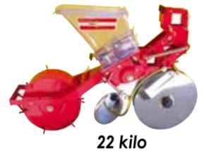
Die modulfähige JPH sät in 1 bis mehr als 8 Reihen auf einer Höchstbreite von 3 Metern.
