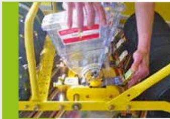
Die Arbeitsweise der Sämaschinen für feinkörniges Saatgut beruht auf einem abnehmbaren Saatbehälter, in dem sich eine Säwalze befindet.
