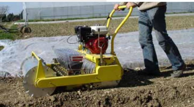
Diese Sämaschinen sind perfekt für die Aussaat von Rettich, Rucola und Sprossen mit 60, 90 und 120 cm Saatbetbreite (6 bis 12 einfache oder doppelte Reihen oder Breitsaat) und 7,5 cm Mindestabstand zwischen den Elementen.
