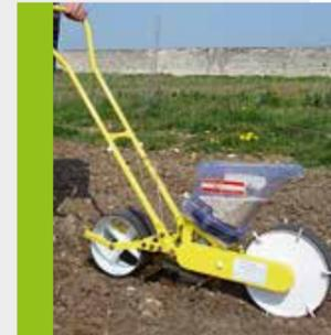
Diese Sämaschinen wurden für die Aussaat von feinkörnigem Saatgut wie Sojabohnen und Soissons-Bohnen entwickelt. Der Saatbehälter mit einem Fassungsvermögen von 5 Litern ist auf solche Sorten bestens eingerichtet.
