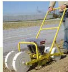
Die JP3 ist auch in einer verstärkten Version für schwierige Bedingungen (steinige Böden) erhältlich: Vorder- und Hinterrad aus Metall, verstärkter Rahmen und verstärkte Radachsen.
