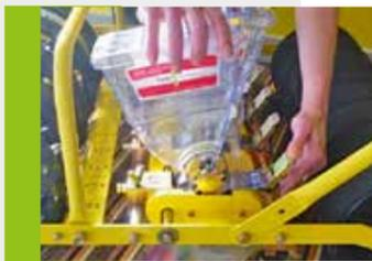
El funcionamiento de las sembradoras de "semillas pequeñas" se basa en el uso de una tolva desmontable, en cuyo interior se aloja un rodillo de siembra. El conjunto de parámetros que aseguran un trabajo de calidad pueden regularse con facilidad: tipo de siembra (en líneas, en hoyo o de monograno), distancia entre las semillas en la línea, profundidad de la siembra, recubrimiento del surco y espacio entre las líneas. Todas nuestras sembradoras están equipadas con sistema de embrague.
