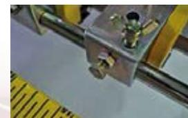
È possibile regolare singolarmente la profondità di semina per ogni fila, svitando i dadi sulla parte frontale dell'elemento di semina.
